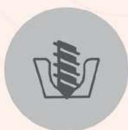
Pre-perfore antes de introducir el tornillo, utilice una broca de 3/32 de diámetro para tornillo #6 y 1/8 para tornillo #8.
